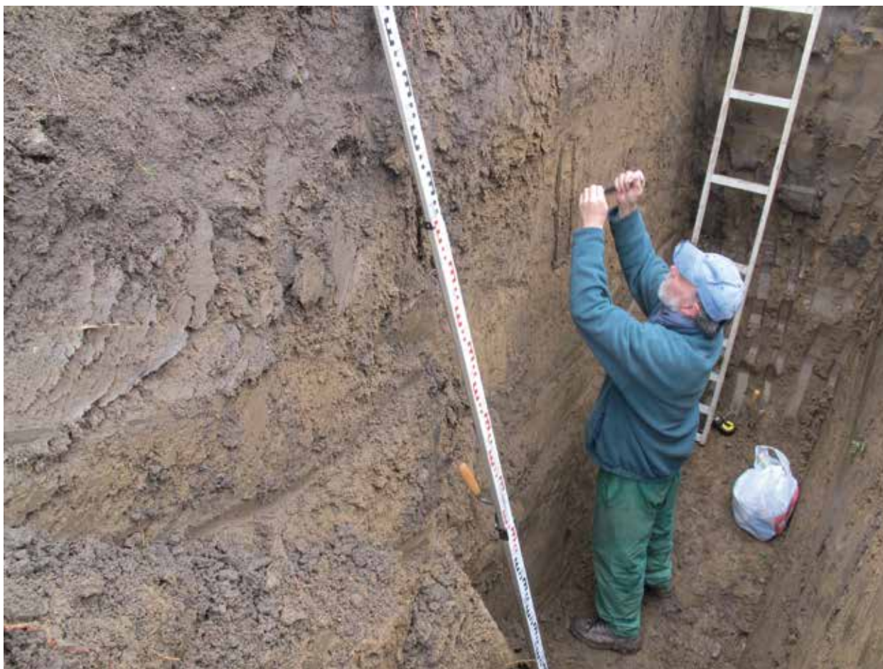
Slika 4. Izdvajanje uzoraka iz geoloških rovova.
