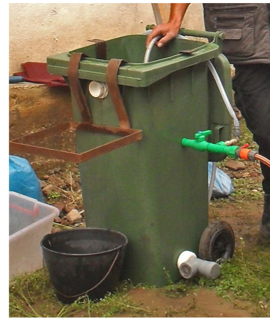
Слика 2. Флотациона машина направљена од доступних материјала која користи воду из славине
