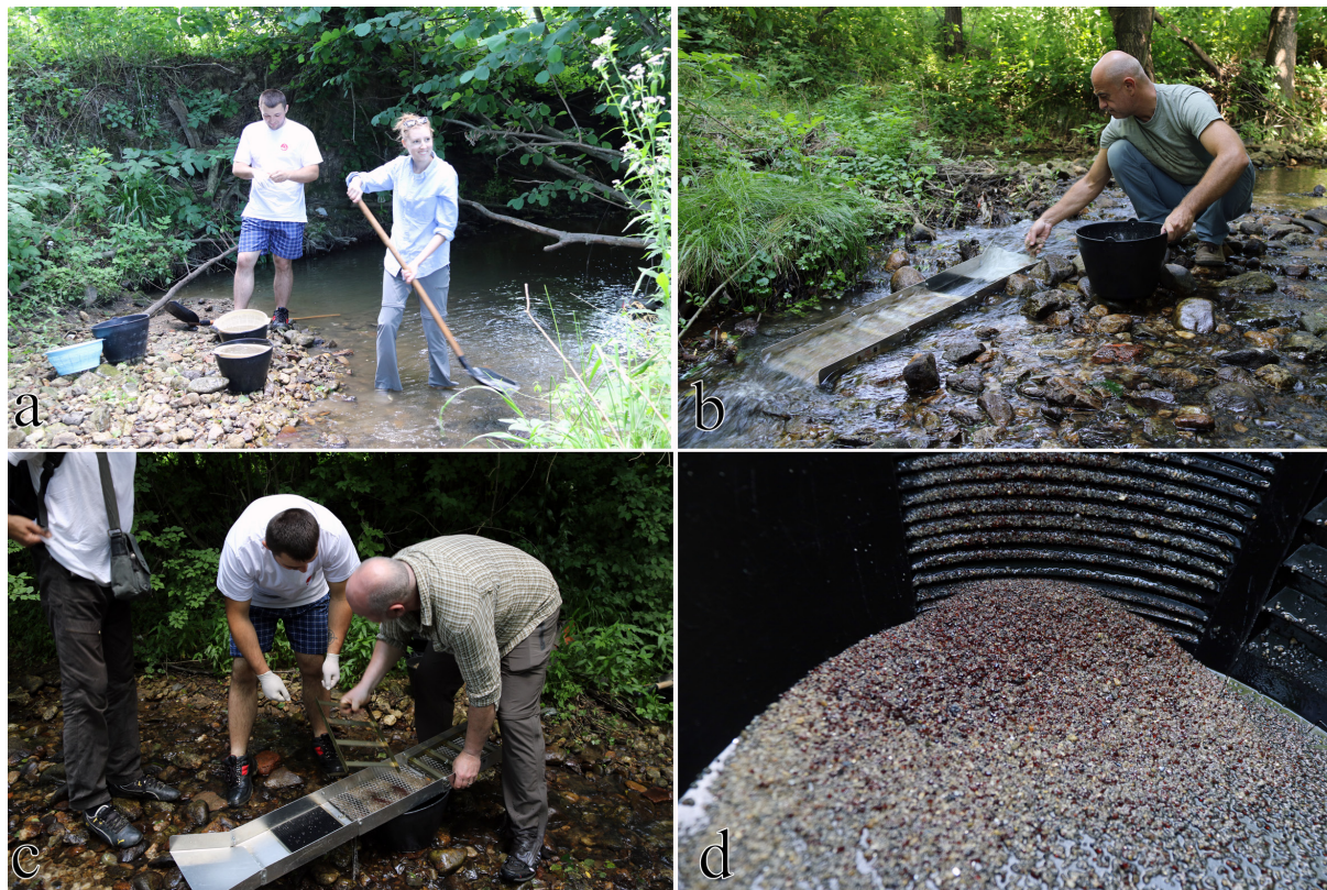
Slika 4 – Uprošćeni sled eksperimenta ispiranja kasiterita iz aluvijalnih nanosa; d: male crne granule kasiterita sa brojnijim zrcima crvenog granata
