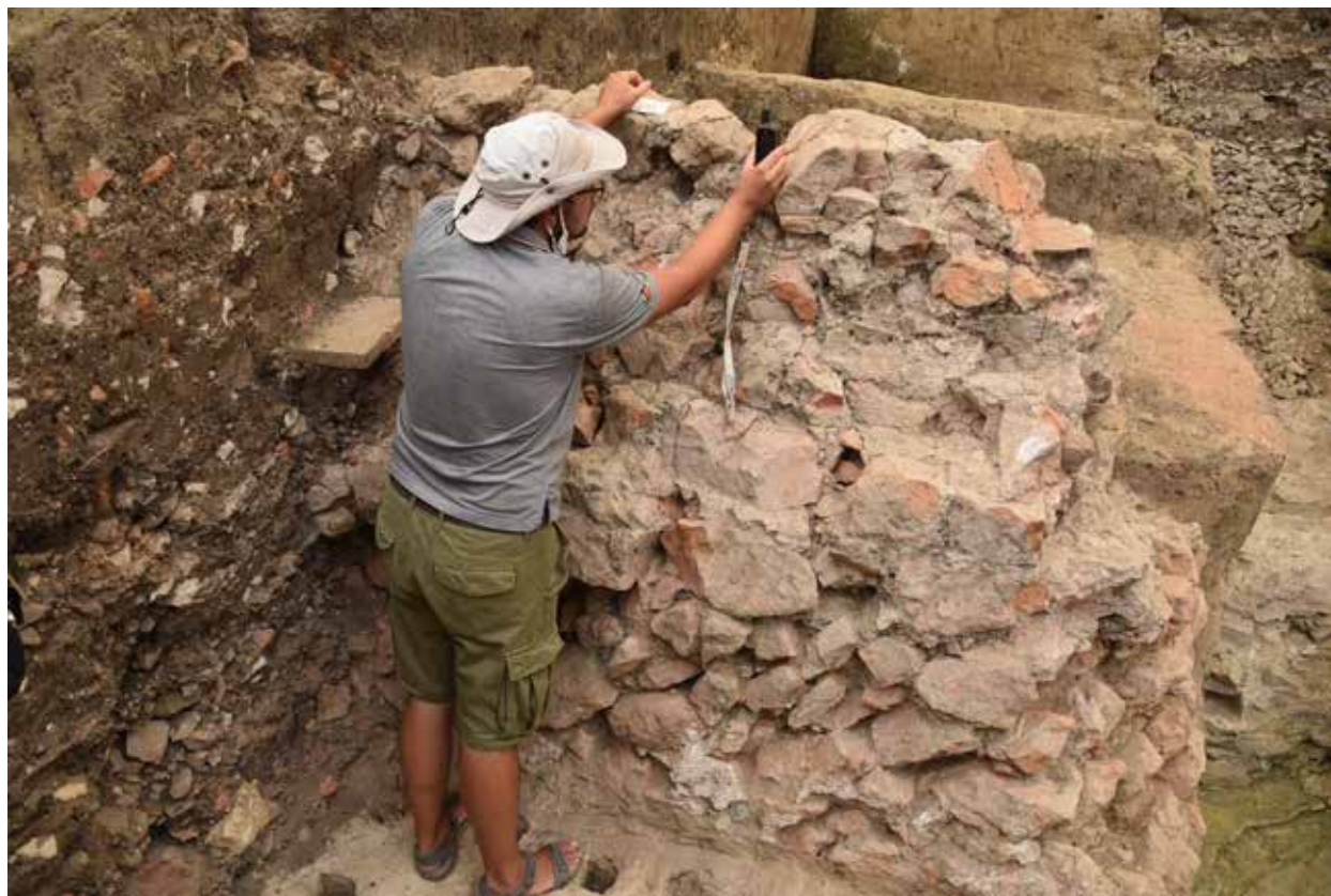
Slika 3 – Uzorkovanje maltera sa severnog bedema legijskog logora na Viminacijumu (Stari Kostolac) (foto-dokumentacija projekta MoDeCo2000).
