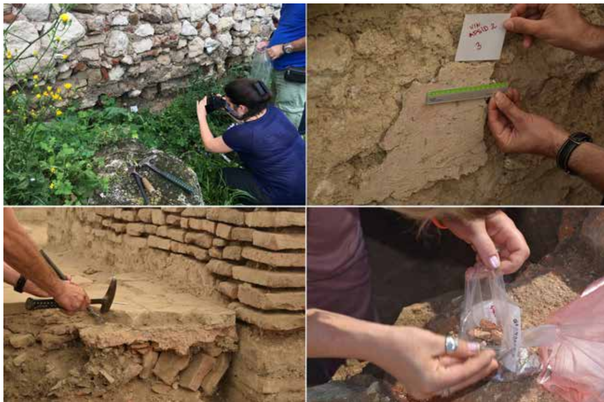
Slika 1 – Proces uzorkovanja maltera na antičkim objektima (foto-dokumentacija projekta MoDeCo2000).
