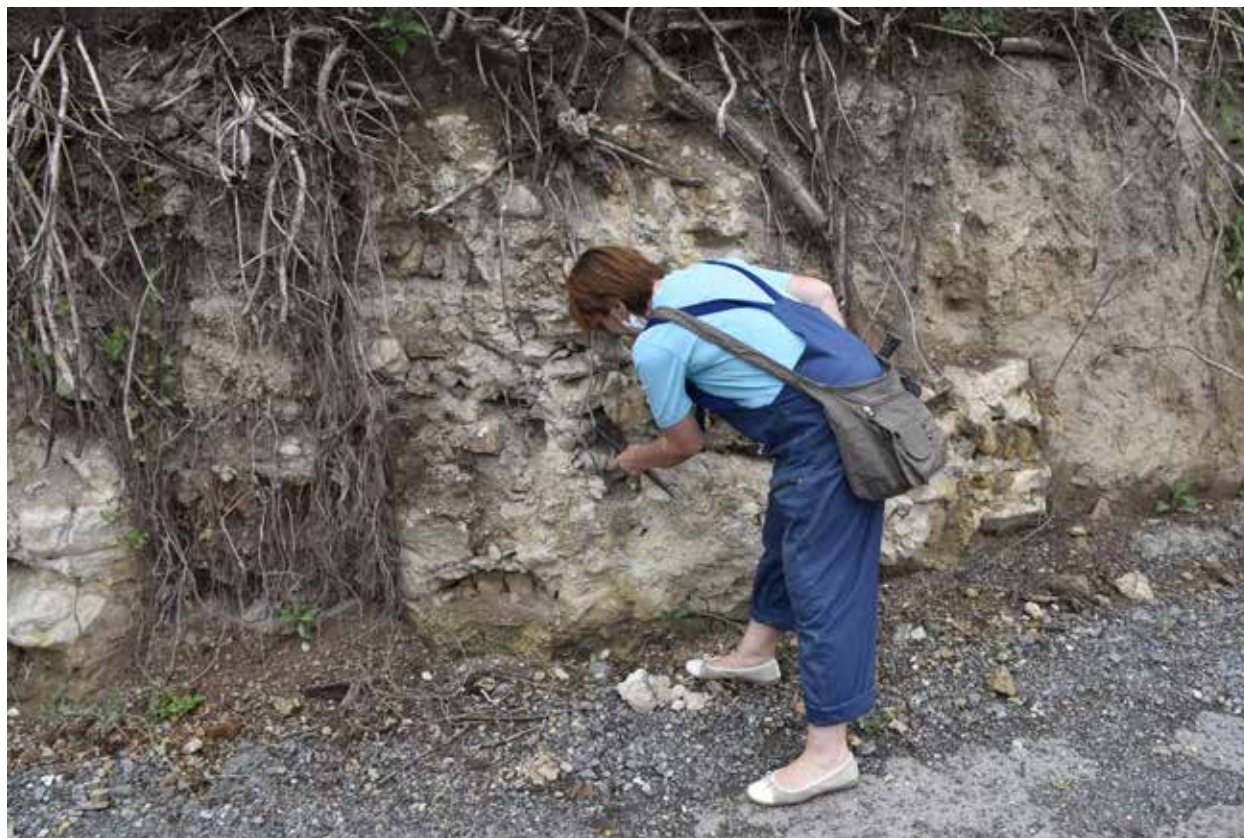
Slika 5 – Uzorkovanje maltera sa ostataka istočnog bedema utvrđenja Ad Octavum (Višnjica) (foto-dokumentacija projekta MoDeCo2000).
