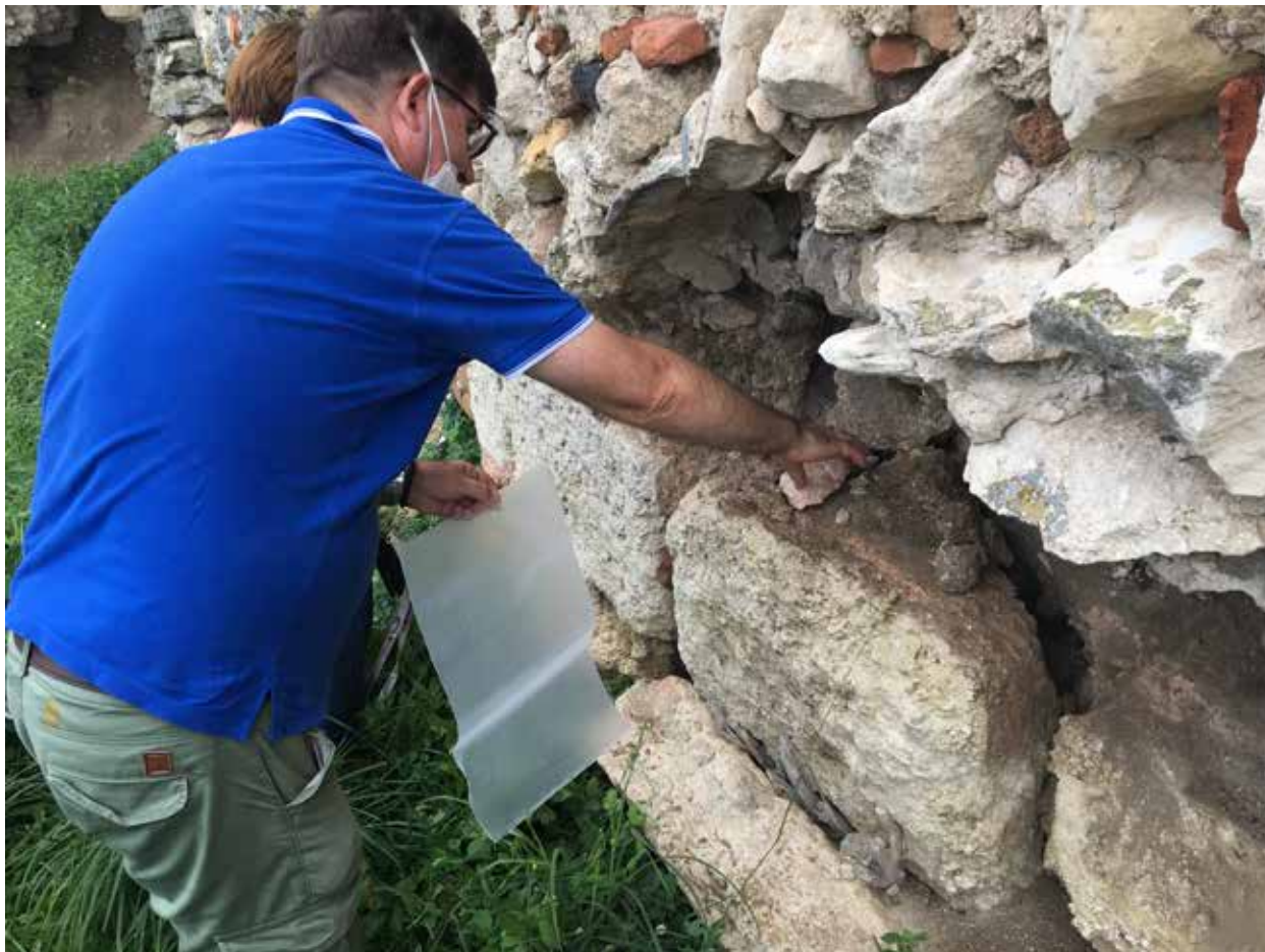
Slika 4 – Uzorkovanje maltera sa ostataka SZ bedema Singidunuma (Beograd) (foto-dokumentacija projekta MoDeCo2000).
