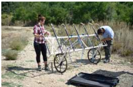
Slika 3 – Multisenzorski sistem za geomagnetna merenja Lea Max
