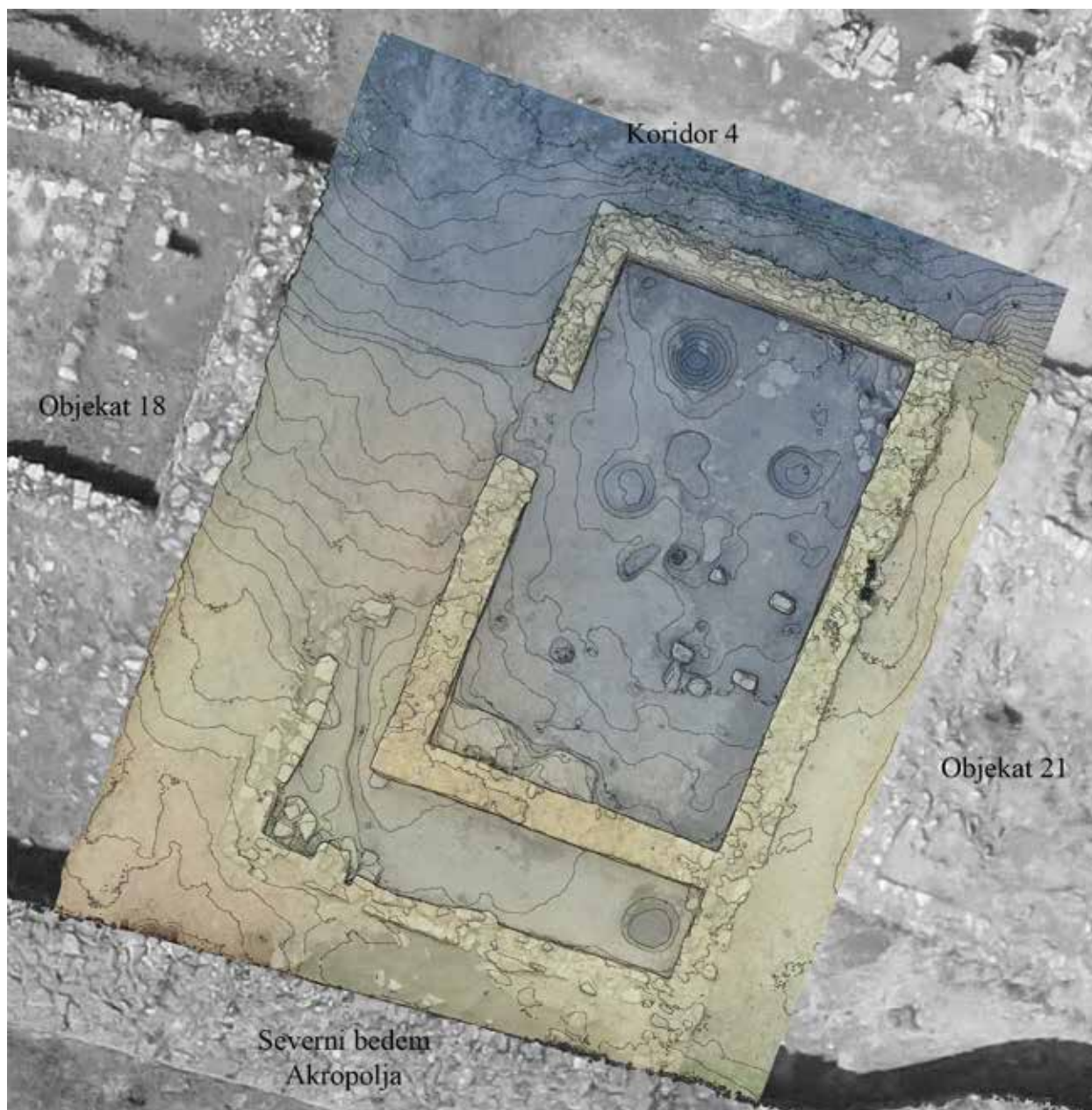
Slika 4. Objekat 22, plan kuće i dvorišta: ortofoto mozaik, DSM, hillshade i izohipse na 0,1 m.
