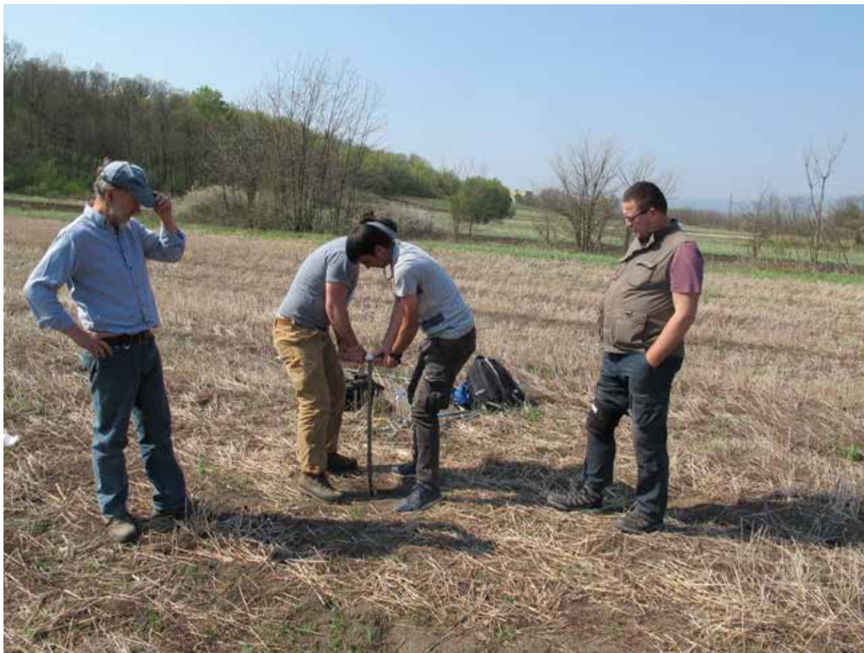
Slika 2. Geoarheološka istraživanja u Drenovcu: uzimanje uzoraka ručnom bušilicom.
