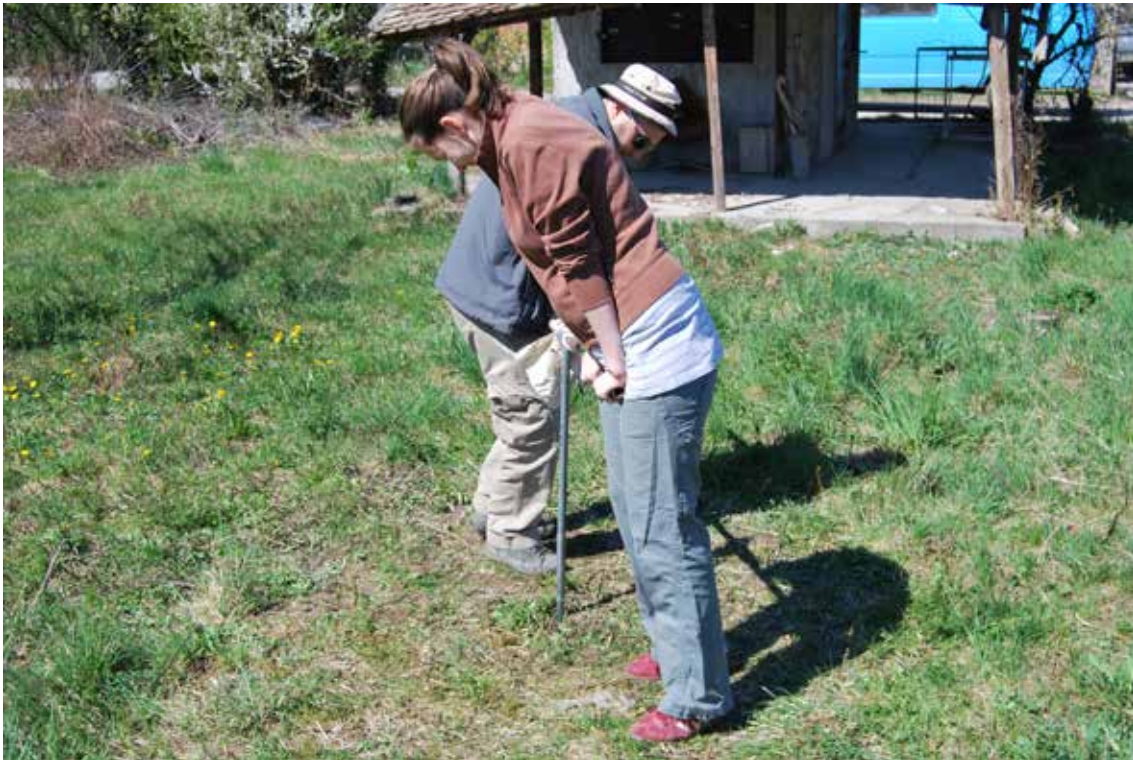
Slika 1. Terensko bušenje i vertikalni položaj bušilice
