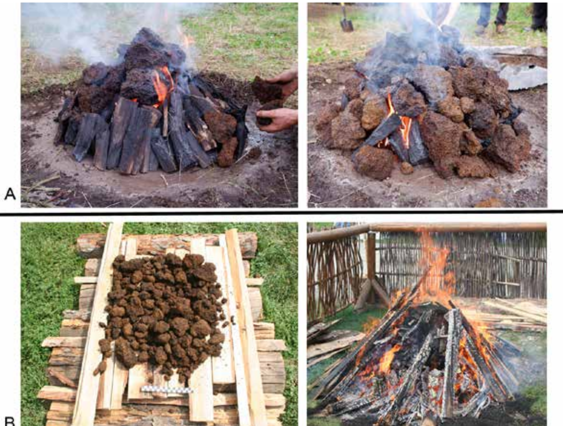
Slika 2. Prženje rude A) Stožasta konstrukcija ložišta, eksperiment 1., B) Rešetkasta konstrukcija ložišta, eksperiment 2.
