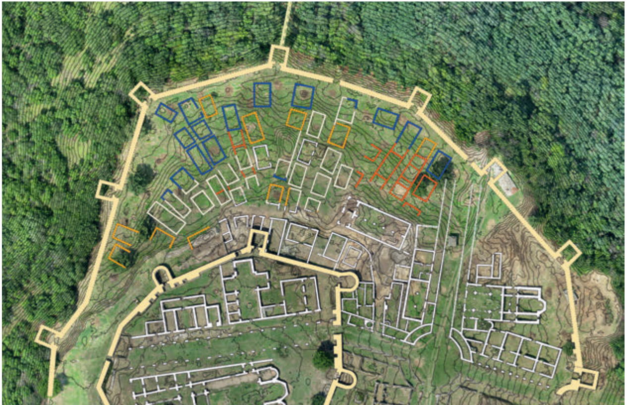
Сл. 8. План северне падине са истраженим целинама (бело) и реконструисаним основама објекта према LiDAR дигиталном моделу (плаво), геоманетским истраживањима (жуто) и георадарским снимањима (наранџасто). Претпостављене основе објекта приказане су тачкастим линијама, као и северни бегем Горњег града и западни одбрамбени зид Северног подграђа. Основу плана чини фотogramетријски снимак из 2014, а изохипсе су даће према LiDAR моделу из 2011. године (документација Археолошког института)
