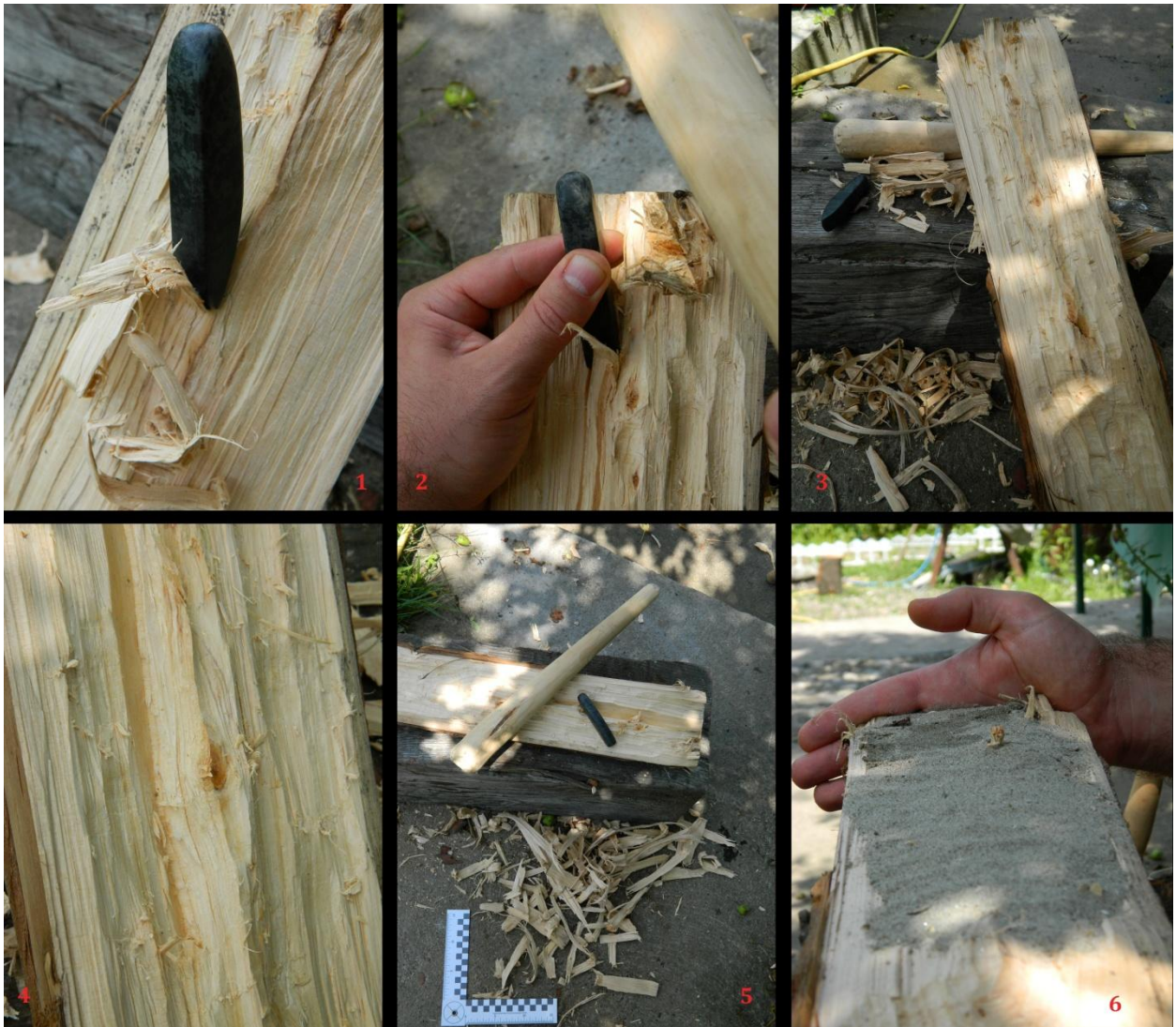
Slika 112. Eksperimentalno dleto 3 (ED 3) / AKT 3 - Dubljenje suvog drveta bora (neograničen prostor).
