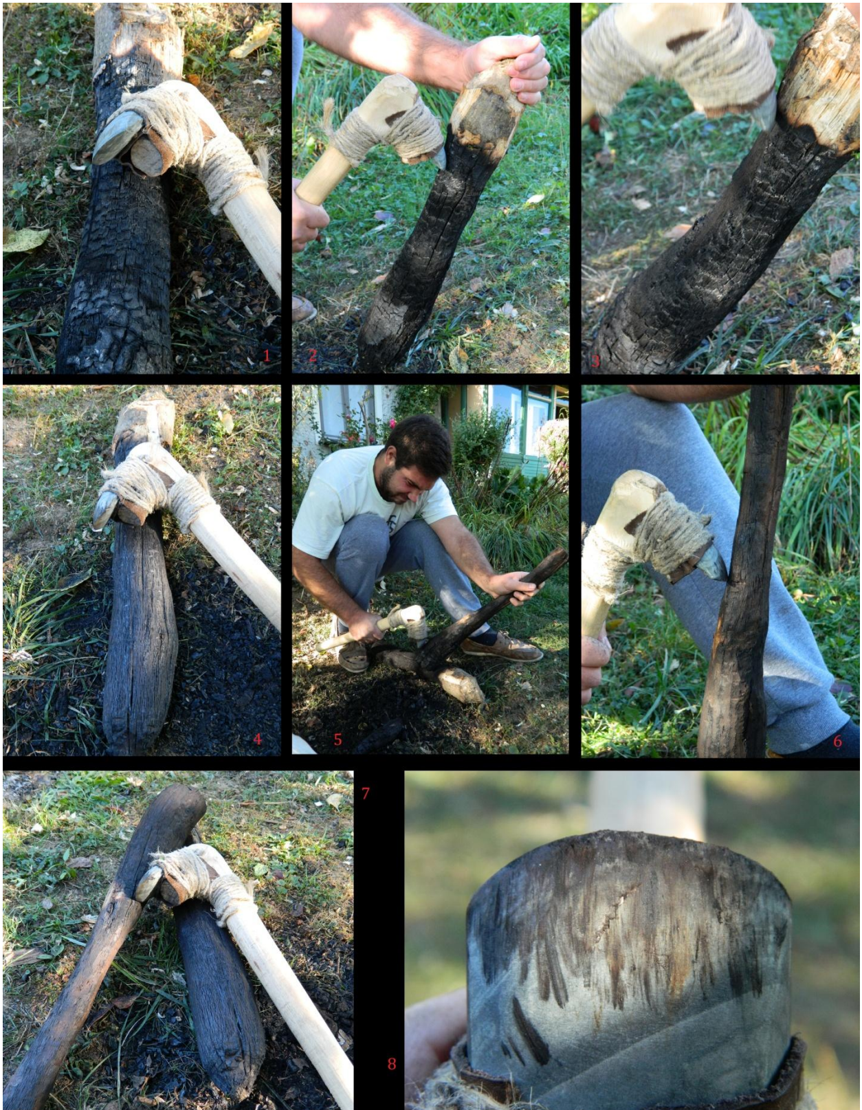
Slika 104. Eksperimentalna tesla 7 (ET 7), AKT 4; Tesanje nagorelog drveta.
