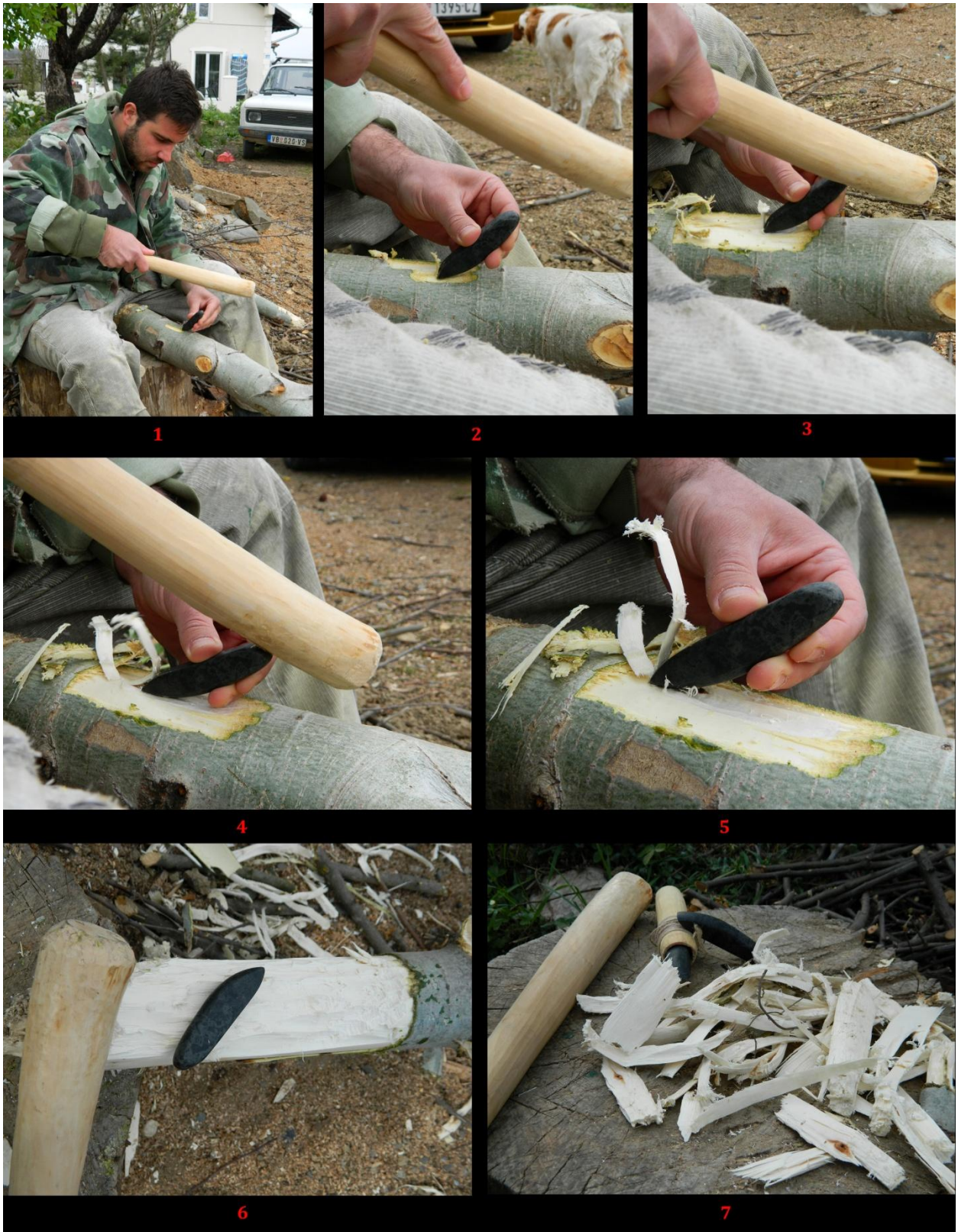
Slika 111. Eksperimentalno dleto 3 (ED 3) / AKT 2 - Dubljenje polusuvog drveta topole (neograničen prostor).
