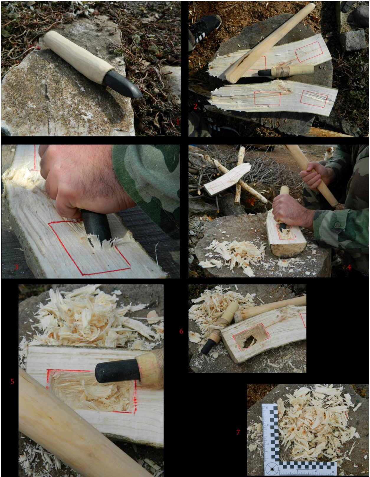
Slika 105. Eksperimentalno dleto 2 (ED 2) / AKT 1 - Dubljenje svežeg drveta topole (ogrančen prostor).
