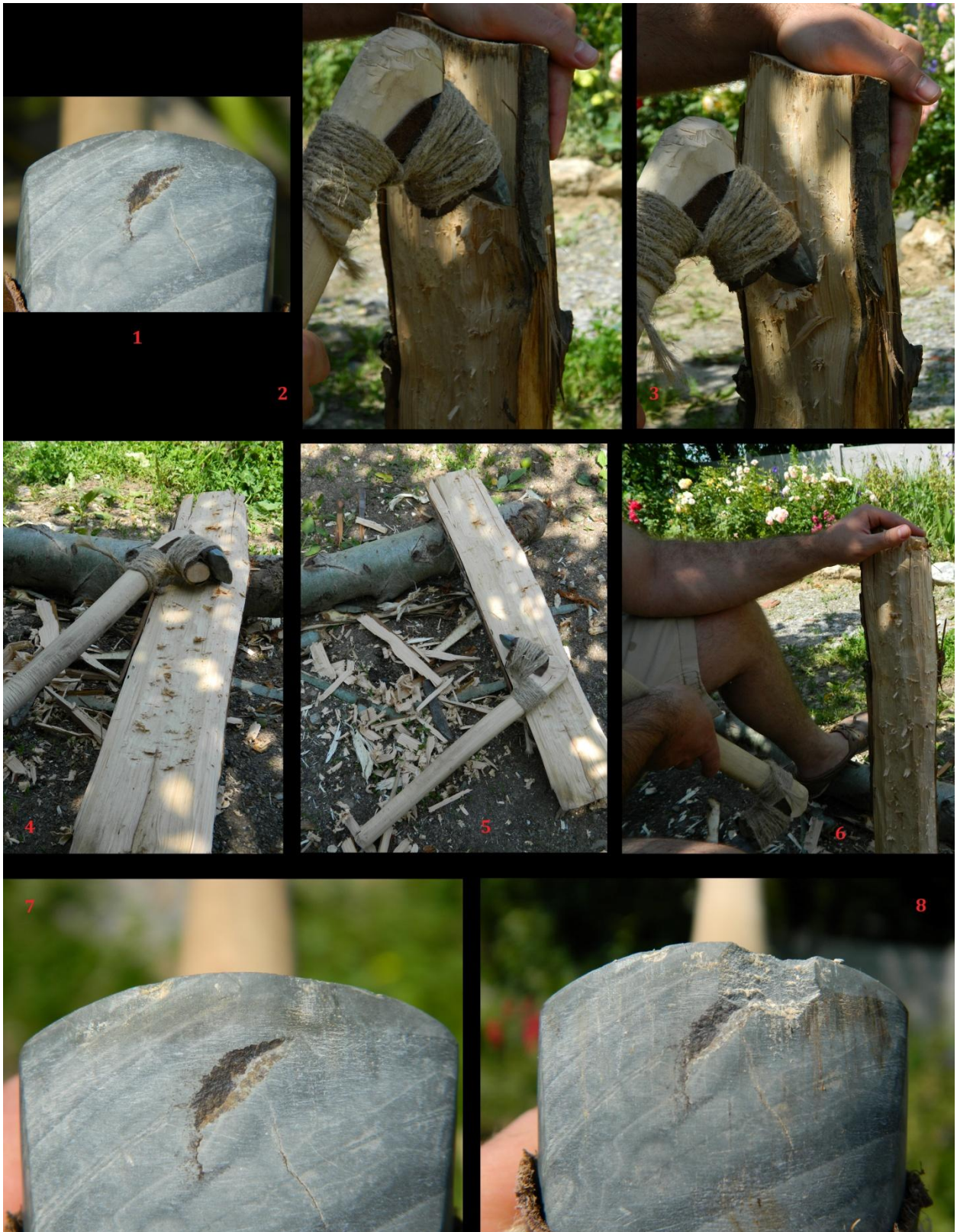
Slika 102. Eksperimentalna tesla 7 (ET 7), AKT 2; Dubljenje drveta.
