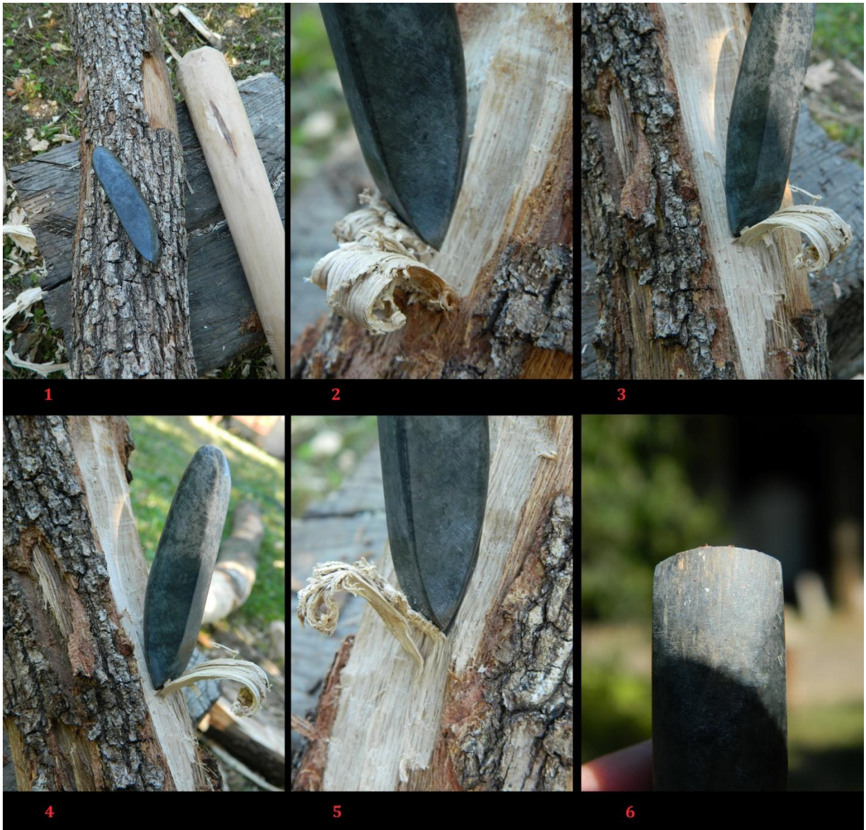
Slika 113. Eksperimentalno dleto 3 (ED 3) / AKT 3 - Dubljenje suvog drveta cera.
