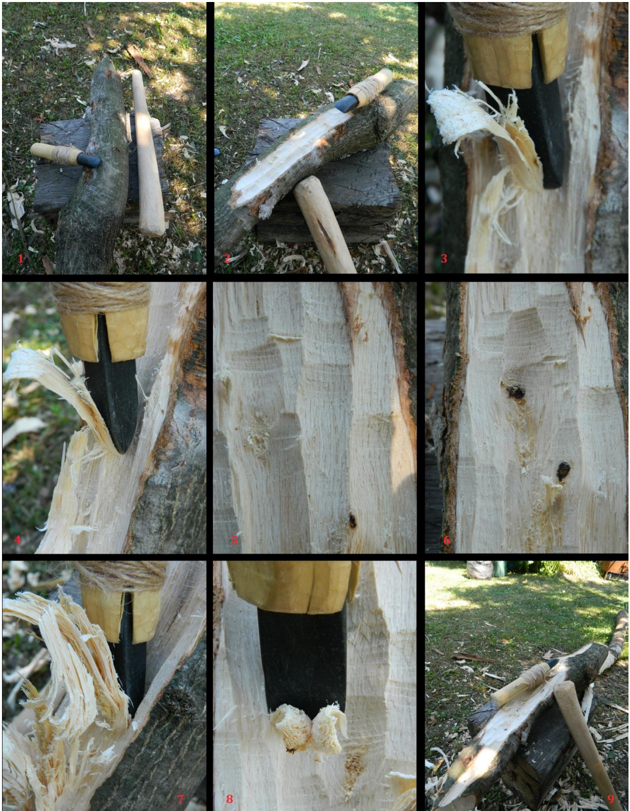
Slika 108. Eksperimentalno dleto 2 (ED 2) / AKT 4 - Dubljenje svežeg drveta hrasta.
