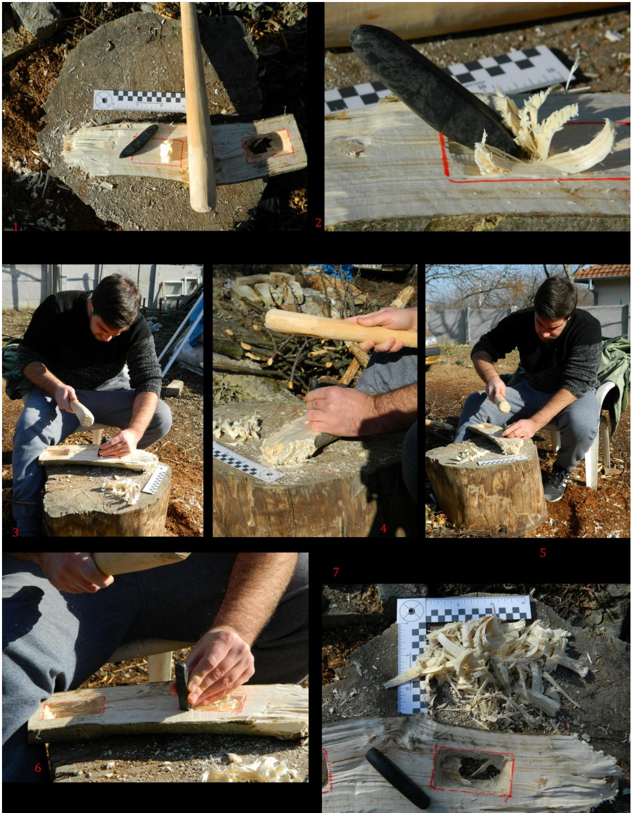
Slika 110. Eksperimentalno dleto 3 (ED 3) / AKT 1 - Dubljenje svežega drveta topole (ogrančen prostor).
