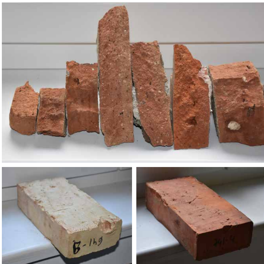
Slika 98. Viminacijumske opeke (gore) i opeke iz domaće poluindustrijske proizvodnje (dole) upotrebljavane kao drobljena ili mlevena sirovina tokom izrade konzervatorskih modela maltera u okviru projekta MoDeCo2000
