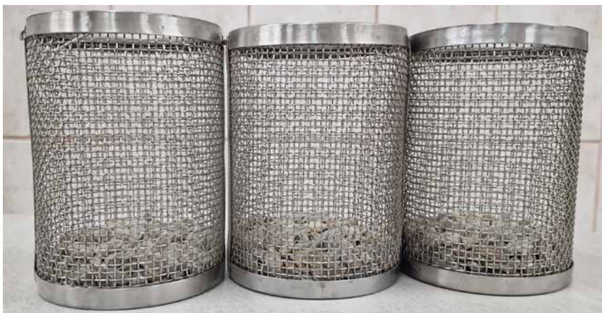
Slika 77. Mrežaste korpice od nerđajućeg čelika za potapanje uzoraka u rastvor magnezijum-sulfata
