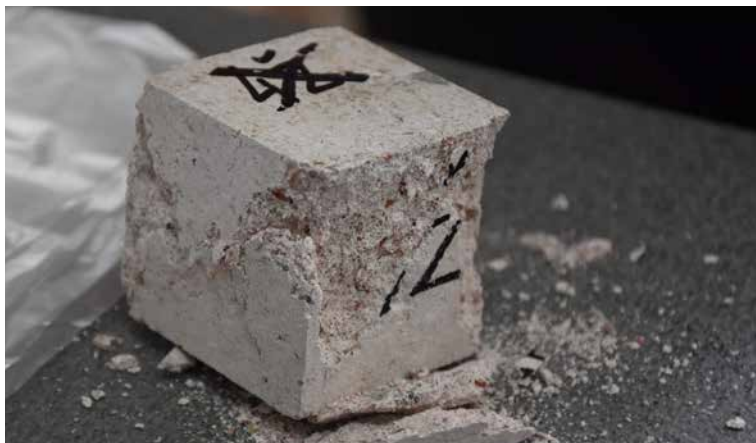
Slika 106. Model maltera nakon ispitivanja čvrstoće na pritisak – vidljiva razlika u boji svežeg preseka i glatke površine
