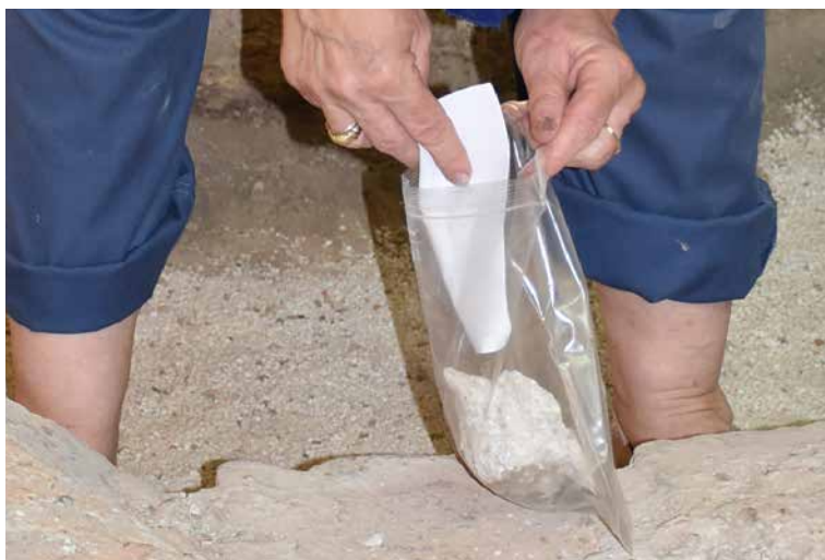
Slika 22. Očitavanje GPS koordinata sa uređaja postavljenog na mesto uzetog uzorka i pakovanje uzorka sa oznakom
