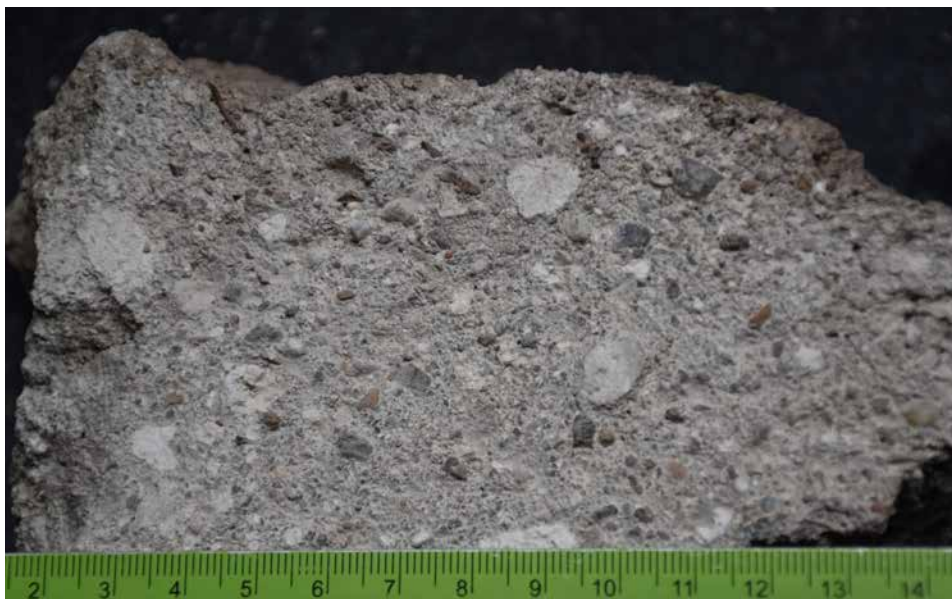
Slika 33. Krečne inkluzije u uzorku maltera
