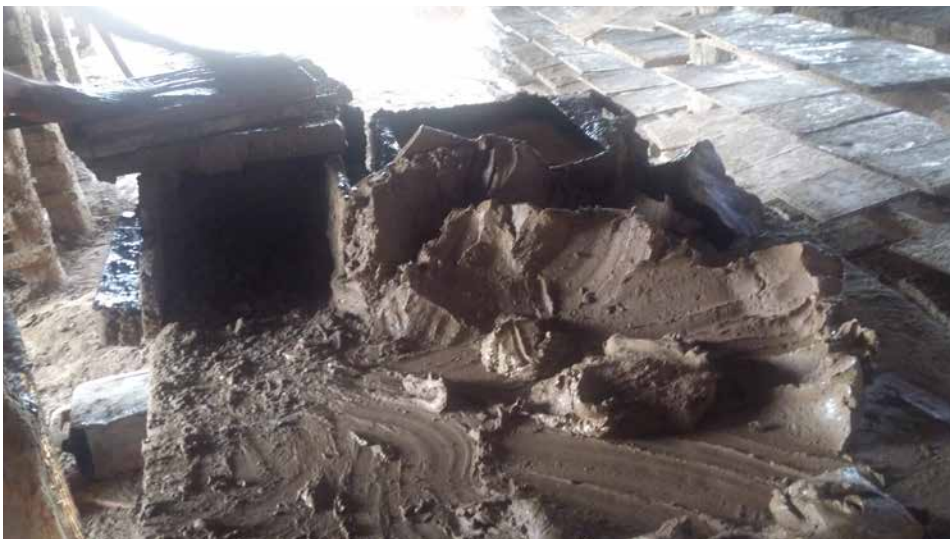
Slika 125. Rimski peč iz Viminacijuma (gore levo); peč za tradicionalnu proizvodnju opeke u selu Poljana koja se koristi i danas (gore desno); izrada opeka u radionici u selu Poljana (dole) (privatna arhiva: Emilija Nikolić)
