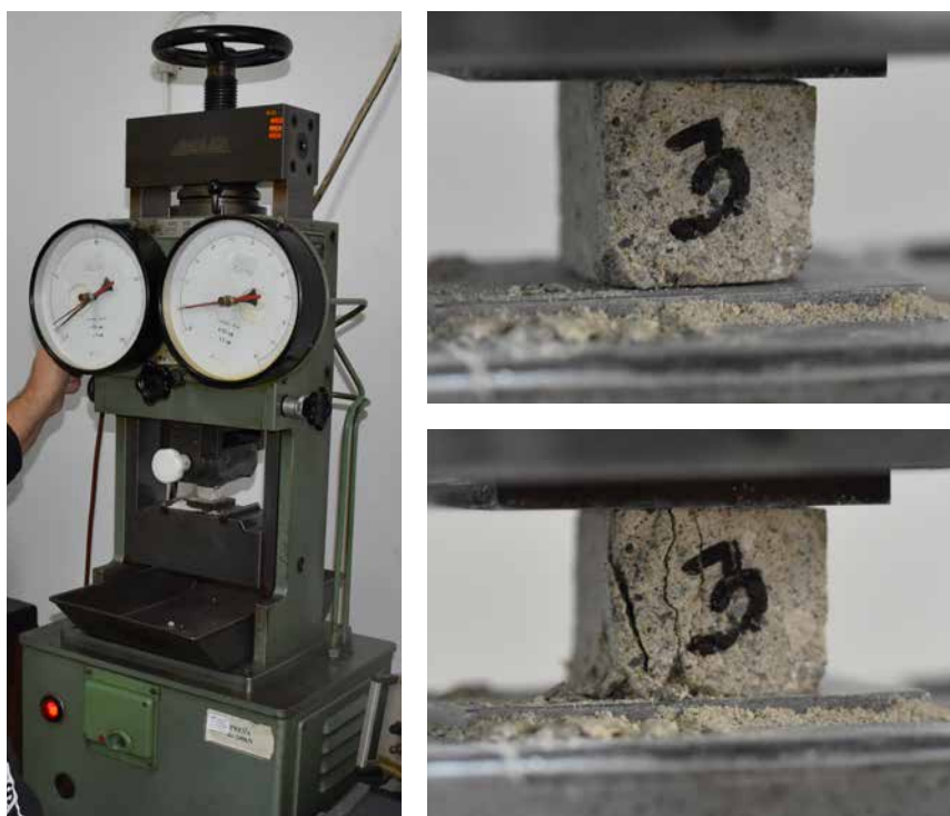
Slika 54. Ispitivanje čvrstoće na pritisak istorijskog maltera u presi
