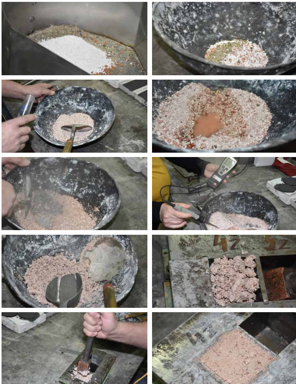
Slika 103. Priprema modela krečnog maltera sa živim krečom u laboratoriji uz ručno mešanje
