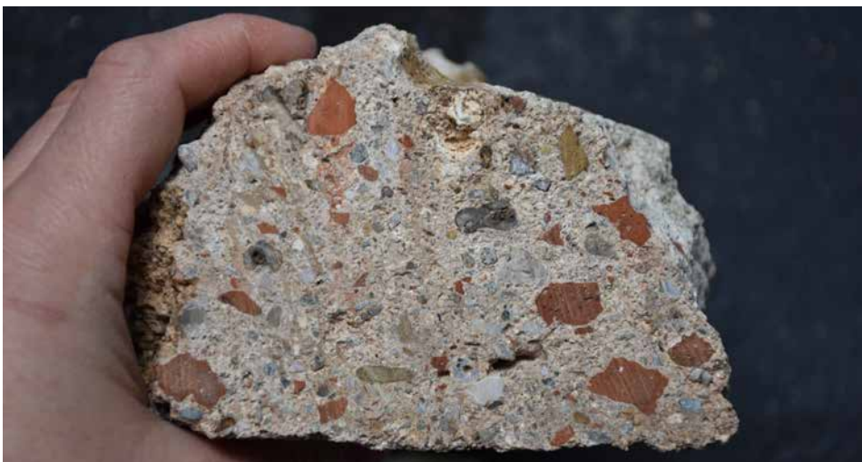
Slika 94. Malter za zidanje iz perioda VI veka sa fragmentima opeke
