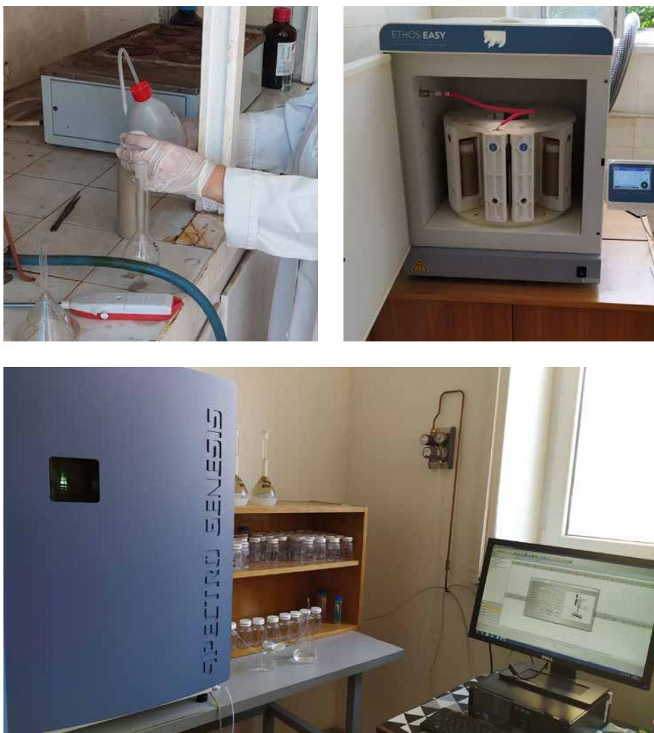
Slika 65. Ispitivanje uzorka istorijskog maltera u ICP-OES uređaju
