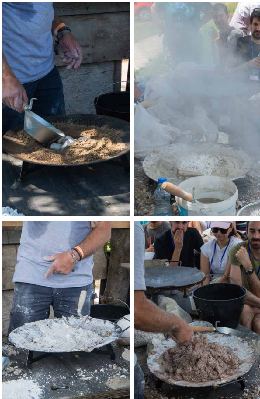
Slika 120. Izrada mešavina maltera za demonstraciju na radionici u Viminacijumu (foto: Goran Stojić)
