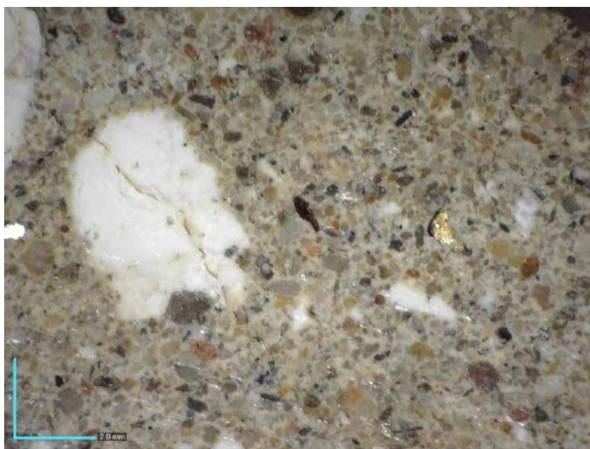
Slika 35. Krečne inkluzije različitih veličina, oblika i homogenosti u jednom uzorku, prisutan razmernik 2 mm (gore); krečna inkluzija sa istaknutom pukotinom po sredini, prisutan razmernik 2 mm (dole)
