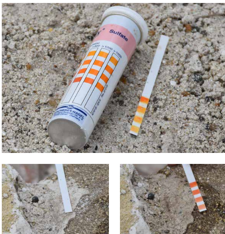
Slika 61. Ispitivanje rastvorljivih soli pomoću reagens traka
