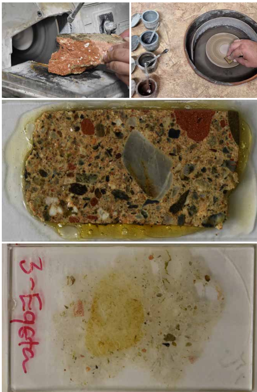
Slika 43. Sečenje uzorka za pripremu petrografskog preparata (gore levo); brusna ploča (gore desno); uzorak maltera zalepljen za predmetno staklo i pripremljen za brušenje (sredina); izbrušen uzorak – pripremljen preparat (dole)
