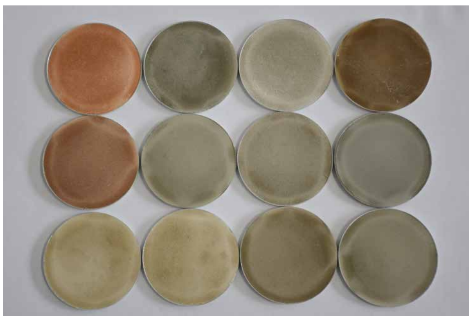
Slika 63. Sprašeni uzorci maltera (gore) i presovani uzorci pripremljeni za XRF analizu (dole)
