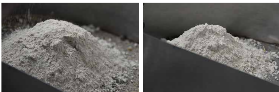
Slika 101. Mleveni zeolitski tuf, Igroš, Brus, Srbija (levo), i uvozni metakaolin (desno) tokom procesa pripreme modela konzervatorskih maltera
