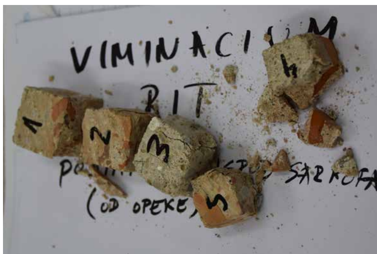
Slika 55. Opitna tela uzorka istorijskog maltera pre (gore) i nakon ispitivanja čvrstoće na pritisak (dole) u presi
