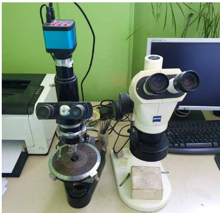
Slika 44. Polarizacioni mikroskop za ispitivanje petrografskih preparata maltera (levo) i stereomikroskop (desno)
