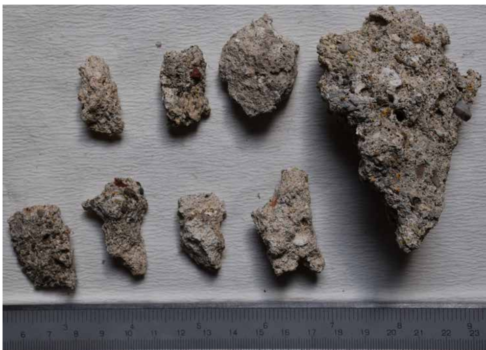
Slika 23. Tipični uzorci istorijskih maltera nakon donošenja u ispitnu laboratoriju
