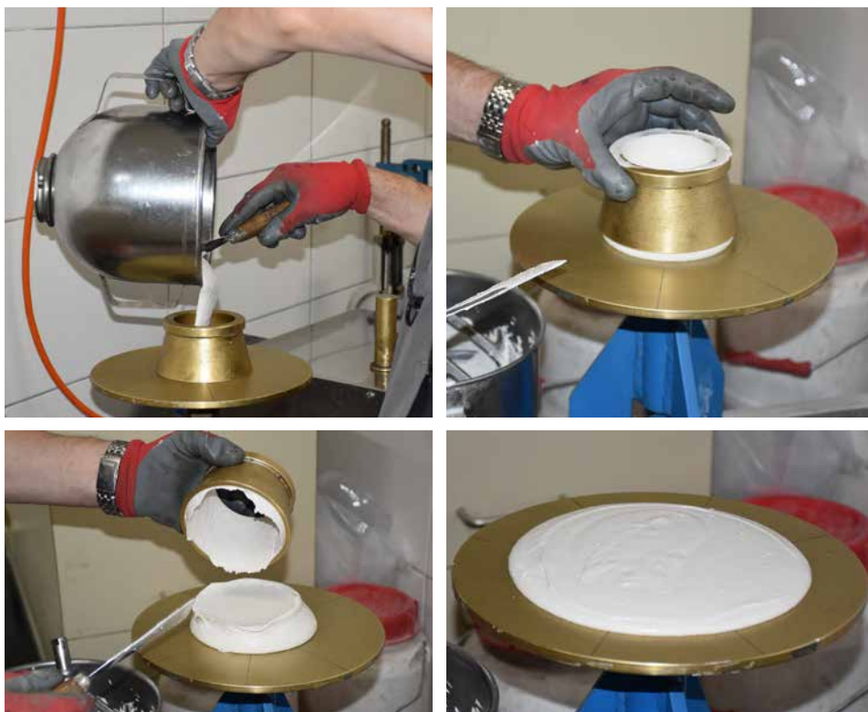
Slika 104. Ispitivanje konzistencije svežeg maltera na potresnom stolu
