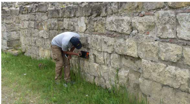
Slika 105. Ispitivanje istorijskih struktura nedestruktivnim metodama (georadar)
