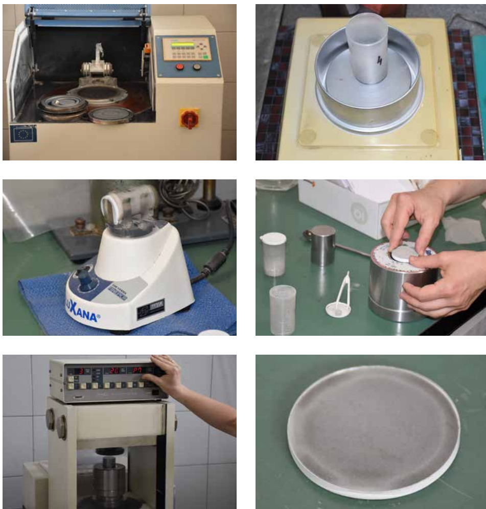
Slika 62. Priprema uzorka za ispitivanje XRF tehnikom (mlin za pripremu uzorka; merenje uzorka; homogenizacija uzorka; postavljanje tablete za ispitivanje u element prese; pokretanje prese za pripremu presovane tablete; tableta nakon izrade
