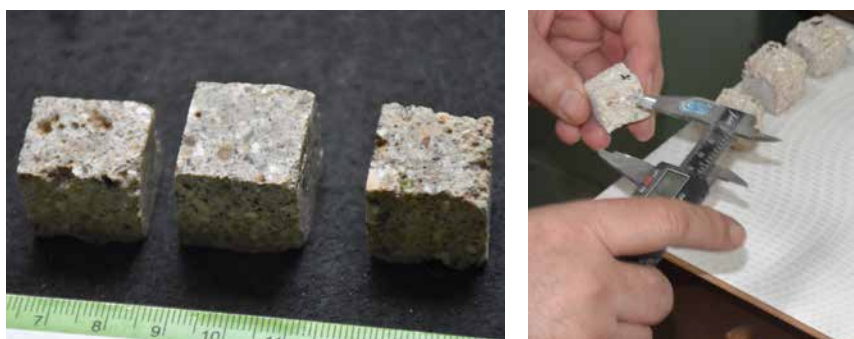
Slika 53. Pripremljena opitna tela istorijskog maltera (levo) i merenje njihovih dimenzija (desno)
