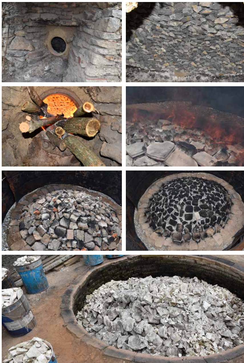
Slika 83. Peć za pečenje kreča u selima Mala Vrbica i Veliki Šenj, Kragujevac: otvor peći za loženje i slog komada krečnjaka (gore); loženje peći i pečenje kreča u peći (pokrov) (sredina); pečeni (živi) kreč u procesu vađenja iz peći (dole)
