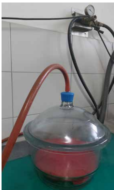
Slika 51. Sud za evakuaciju vazduha (levo); dodavanje sprašenog uzorka u sud sa dejonizovanom vodom (desno)
