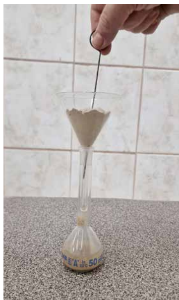
Slika 51. Sud za evakuaciju vazduha (levo); dodavanje sprašenog uzorka u sud sa dejonizovanom vodom (desno)
