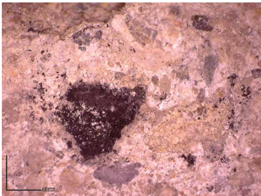
Slika 37. Čestice ugljena (uglja), prisutan razmernik 2 mm
