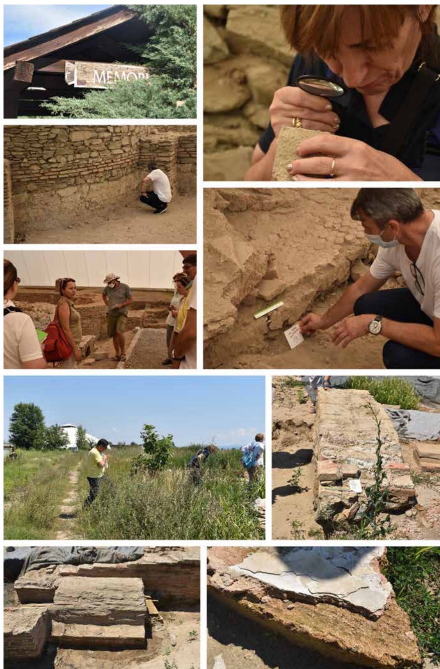
Slika 4. Uzorkovanje maltera grada Viminacijuma (priprema kolaža: Konstantin Janjić)
