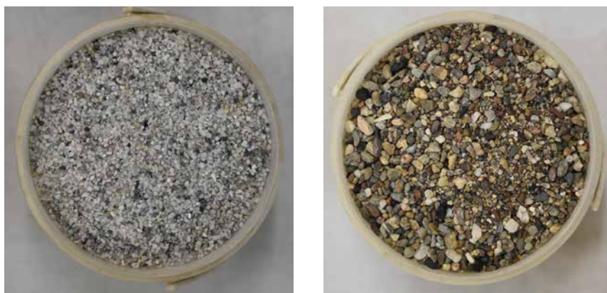
Slika 70. Pesak: prirodni, heterogenog mineralnog sastava (levo); monomineralni (kvarcni) pesak (desno) – poreklom iz Srbije
