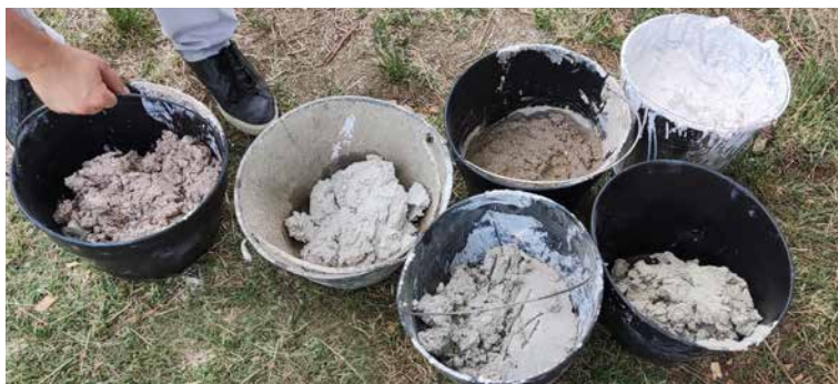
Slika 1. Mešavine tradicionalnih maltera odmah nakon pripreme, nastale od različitih agregata, veziva i dodataka
