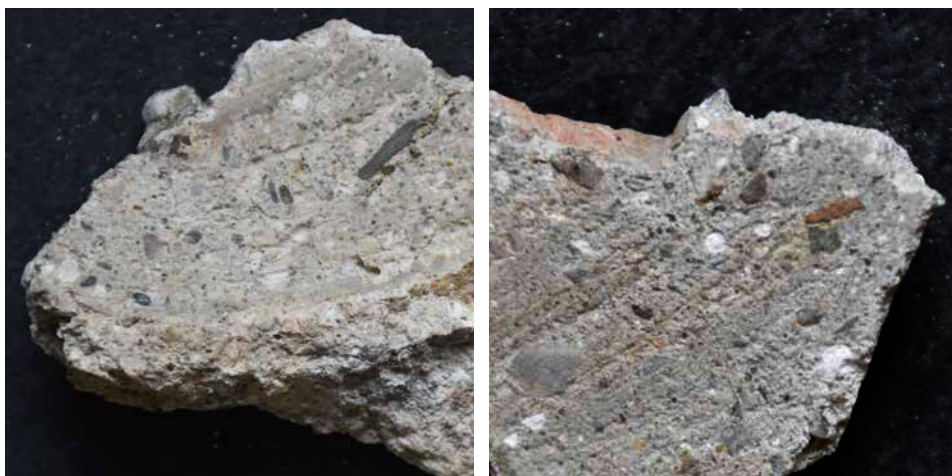
Slika 19. Tehnička kompatibilnost istorijskog (levo) i konzervatorskog maltera (desno) izgrađenog za jednu od rimskih građevina dunavskog limesa u Srbiji dostignuta kroz projekat MoDeCo2000
