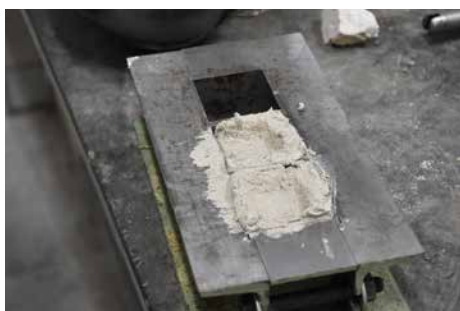
Slika 102. Priprema modela krečnog maltera sa gašenim krečom u laboratoriji uz upotrebu miksera
