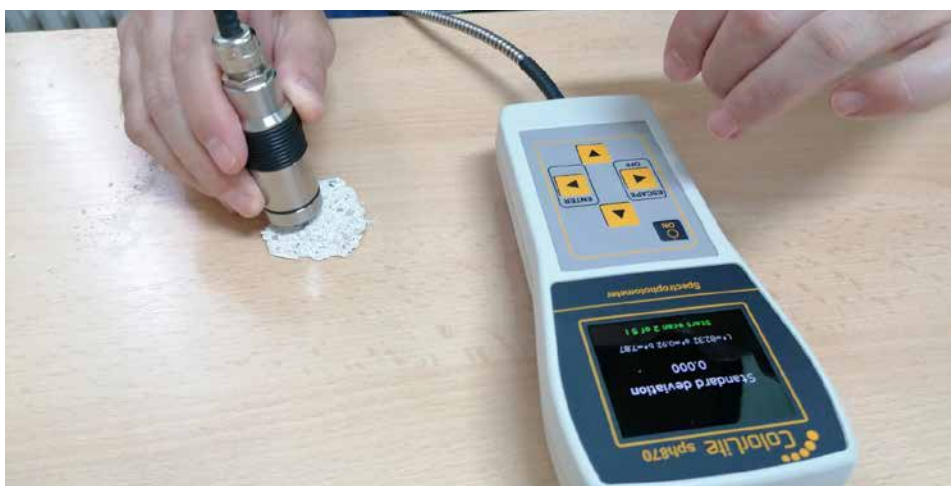
Slika 42. Kolorimetrijsko ispitivanje boje uzorka maltera
