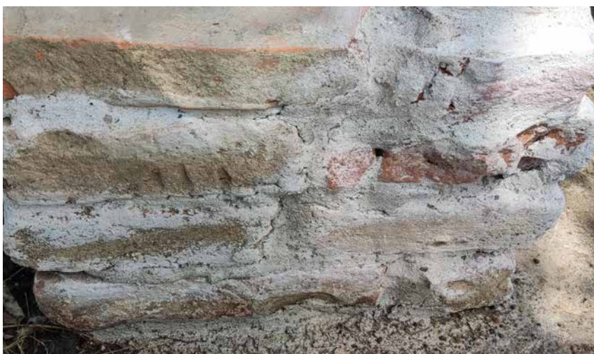
Slika 117a. Monitoring primenjenih mešavina maltera na zidanim strukturama u Viminacijumu: Struktura 4 – tek ozidano, jun (gore); nakon sedam dana, jun (dole)
