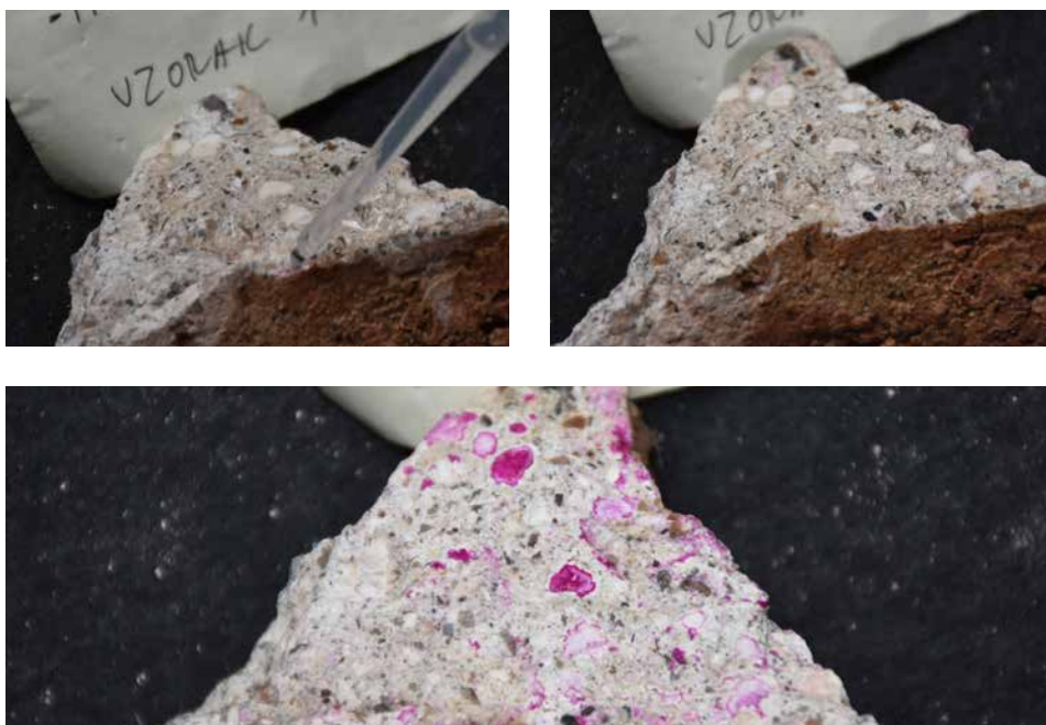
Slika 112. Indikacija nekompletne karbonatizacije (u slučaju krečnih grudvica) fenolftaleinom – malter star nešto više od pet vekova
