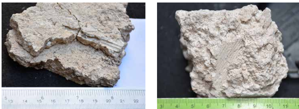
Slika 38. Tragovi biljnih vlakana u uzorcima istorijskih maltera za malterisanje vidljivi golim okom
