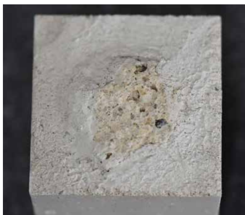
Slika 113. Fragment istorijskog maltera utisnut u kompatibilni laboratorijski model maltera
