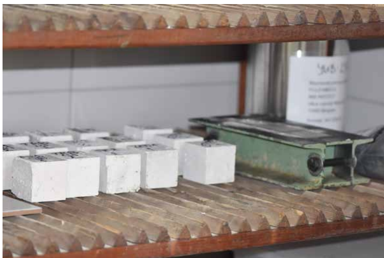
Slika 110. Modeli konzervatorskih maltera u procesu standardnog starenja
