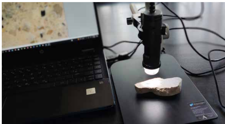
Slika 25. Ispitivanje svežeg preseka uzorka maltera pod prenosnom digitalnom opremom za uvećanje
