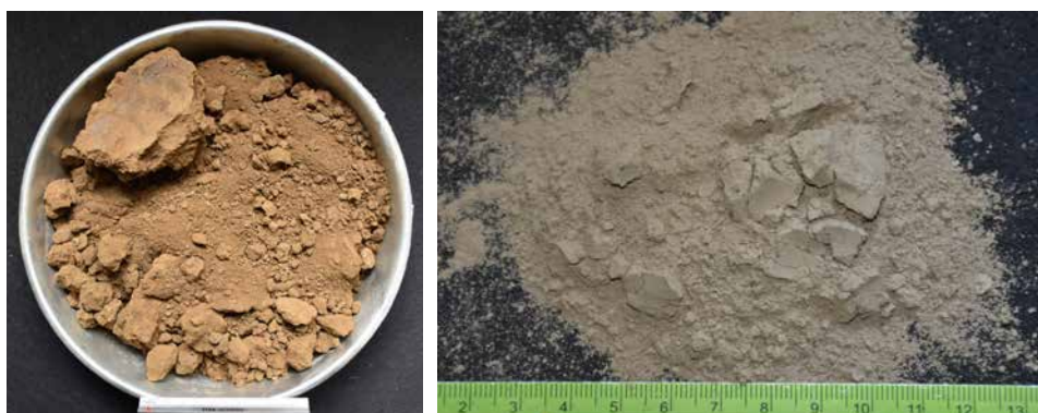
Slika 100. Glina nakon eksploatacije (levo) i mlevena glina (desno), selo Poljana kod Požarevca, Srbija
