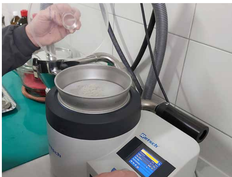
Slika 97. Priprema tačno određene granulacije određenih komponenata modela konzervatorskih maltera
