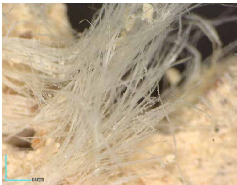
Slika 95. Vlakna životinjskog porekla u istorijskom malteru za malterisanje starom nekoliko vekova, koja su se održala do danas, prisutan razmernik 0,5 mm (Arhiva Laboratorije za kamen i agregat Instituta IMS)
