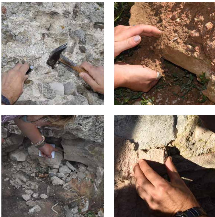
Slika 21. Ručno uzorkovanje maltera: konsolidovanih uzoraka pomoću čekića i dleta (gore levo); potpuno odvojenih od strukture i sprašenih uzoraka (gore desno); potpuno odvojenih od strukture i fragmentovanih uzoraka (dole levo); uzoraka delimično odvojenih od strukture (dole desno)
