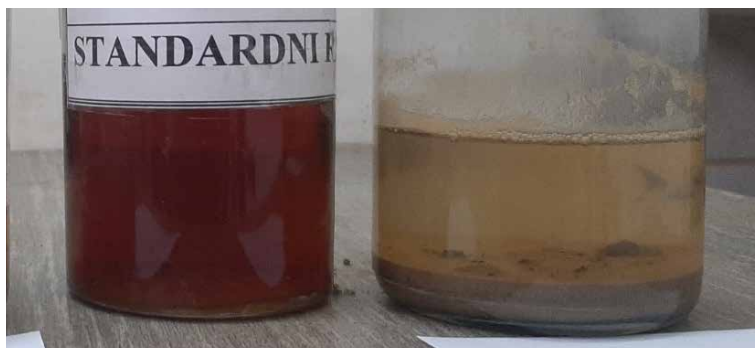
Slika 76. Rastvor standardne boje (u skladu sa SRPS EN 1744-1: 2014) u poređenju sa peskom sa sadržajem organske materije (gore) i peskom bez sadržaja organske materije (dole)
