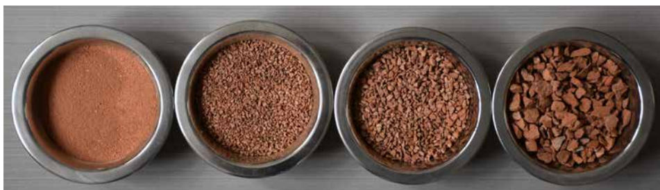
Slika 92. Mlevena opeka i različite granulacije drobljene rimske opeke iz Viminacijuma
