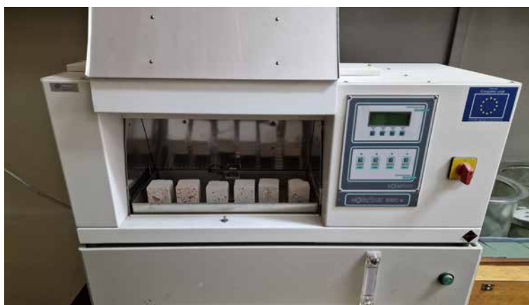
Slika 111. Ubrzano starenje modela konzervatorskih maltera u programabilnoj klimatskoj komori sa simulacijom uslova u kojima će konzervatorski malteri biti primenjeni
