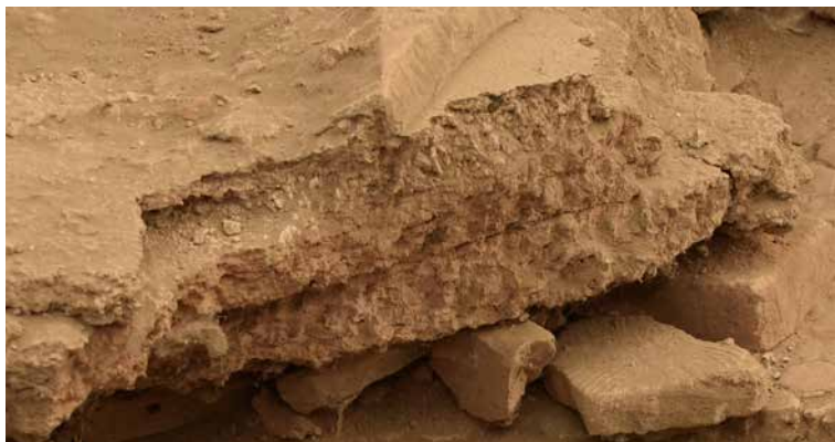
Slika 11. Rimski malteri dunavskog limesa u Srbiji za podove (slojevi iz više faza građevine): Viminacijum
