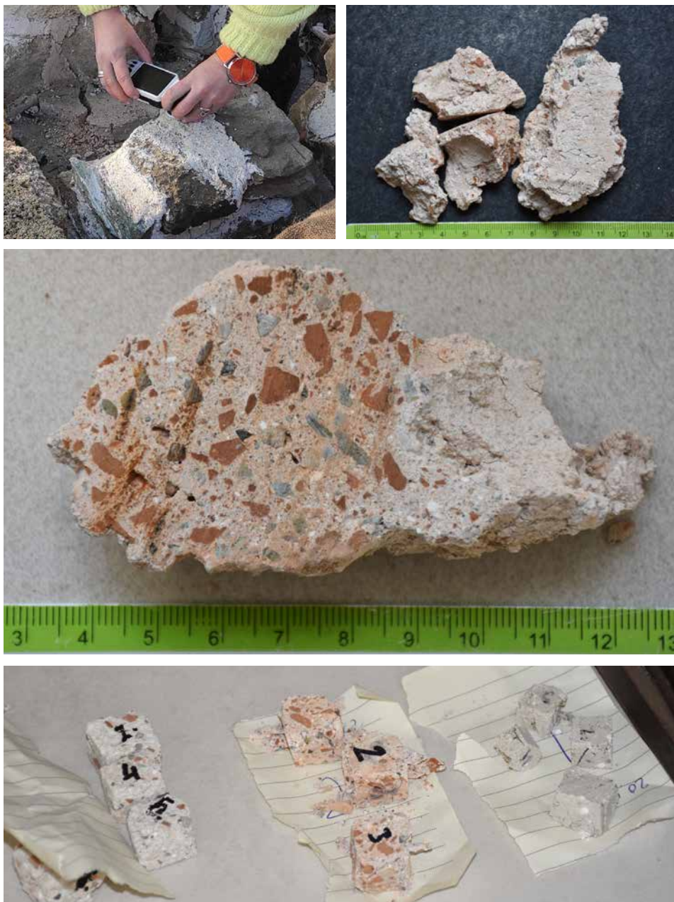
Slika 118. Ocena kontakta istorijskih materijala za zidanje i novog maltera na eksperimentalnoj zidanoj strukturi u Viminacijumu mobilnom opremom (gore levo); malter uzorkovan sa jedne od struktura (gore desno i sredina); uzorci uzeti sa više struktura nakon ispitivanja čvrstoće na pritisak (dole)
