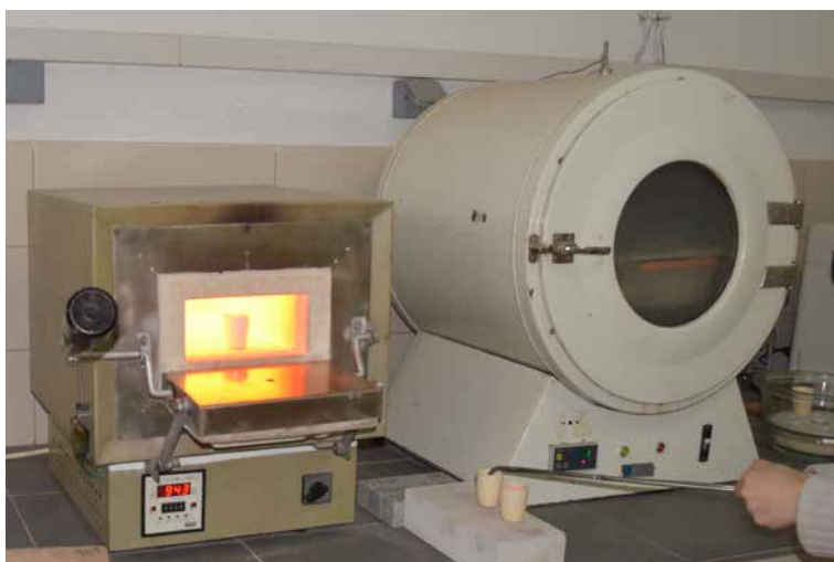
Slika 66. Postavljanje uzoraka u sušnicu (gore); spraseni uzorak u pećnici i zatvorena sušnica (dole)
