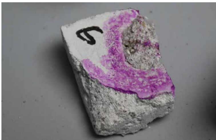
Slika 115. Indikacija procesa karbonatizacije fenolftaleinom kod očvrsllog kompatibilnog modela maltera za konzervaciju u kontaktnoj zoni sa umetnutim fragmentom uzorka istorijskog maltera
