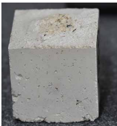
Slika 113. Fragment istorijskog maltera utisnut u kompatibilni laboratorijski model maltera
