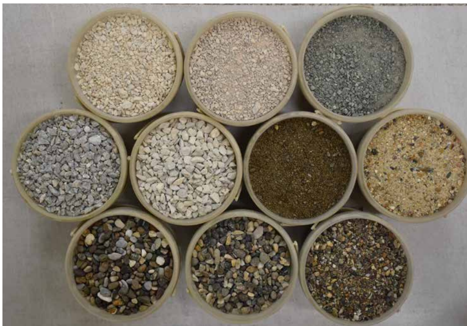
Slika 73. Agregati različitih granulacija, prirodni i drobljeni- poreklom iz Srbije
