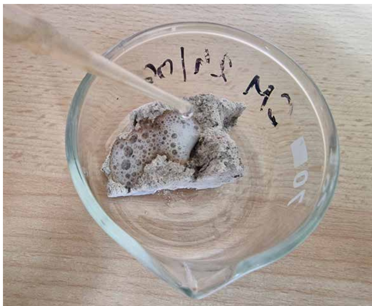
Slika 29. Reakcija karbonatnog veziva u istorijskom malteru sa HCl
