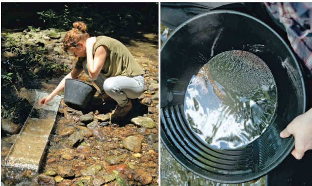
Обр. 1. Промиване и набогатяване на каситерит с помощта на портативен улей и на панер по поречието на Милинска река
