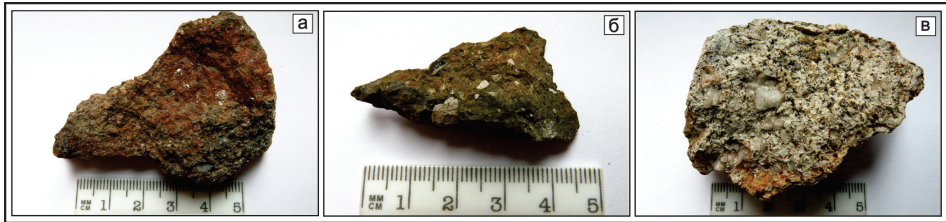
Сл. 4. Макроскопски изглед испитиваних кварцлатита: а – површина узорка прекривена лимонитском скрамом (узорак MNJ4877); б – изразита порфириска структура са уочљивим млечнобелим фенокристалима фелдспата (узорак MNJ4964); в – алтерисана стенска маса (узорак MNJ4163)
